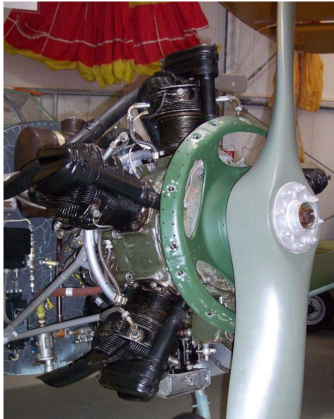
1. ábra Csillagmotor légsavarral (forrás: http://hu.wikipedia.org/wiki/Svecov_M-11 )
